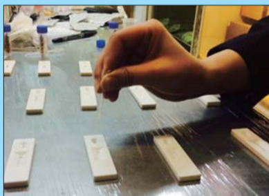
快检卡能快速检测出食品添加剂是否超标。
