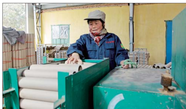
第二步，打底。将制作好的纸筒放入机器，机器将在纸筒的一端装土。
