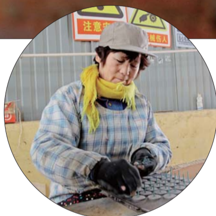
将引线插入引孔中。
