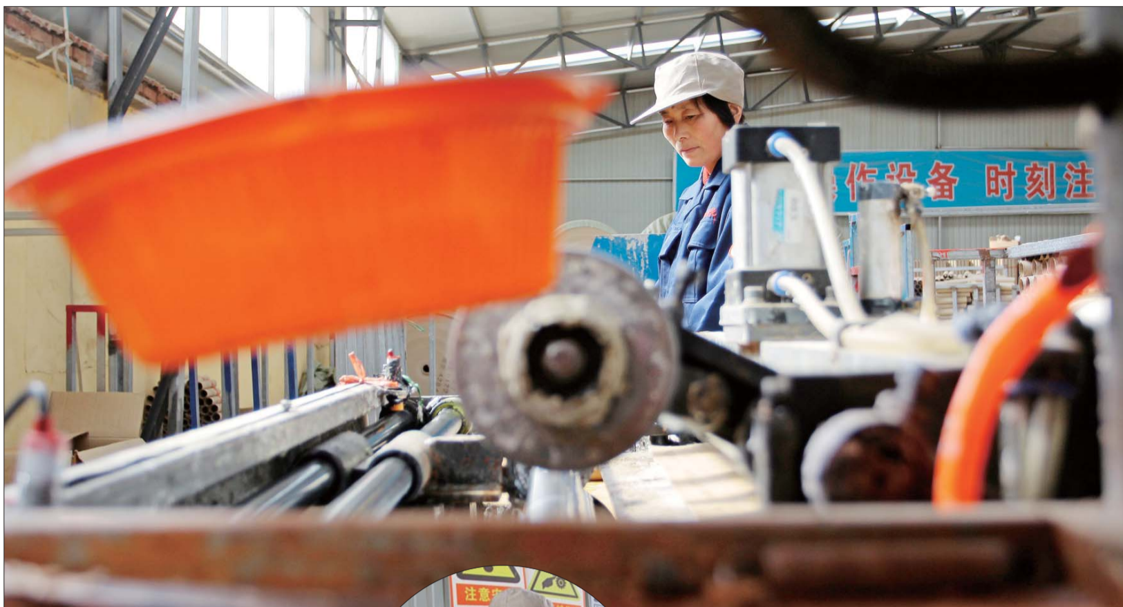
第一步，卷筒。将纸卷通过机器卷成一个个纸筒。
