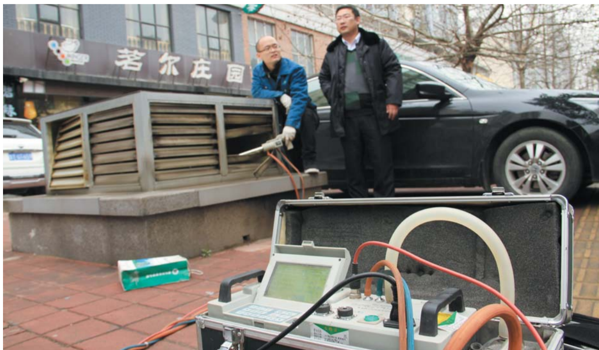
环保部门的工作人员对餐厅排放的油烟进行取样。
