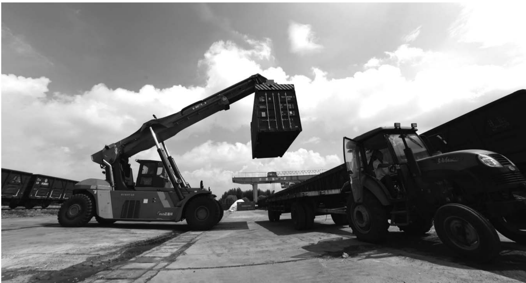
在临沂火车站北站,正面吊正在装卸临沂欧货运班列货物。
